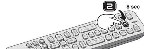
**IT** Tenere premuto il tasto numerico **"2"** per almeno **8 secondi**. Tre lampeggi finali del LED indicano che l'operazione si è conclusa in modo regolare.
