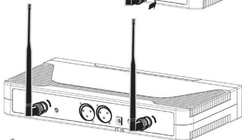
Aparafuse as duas antenas girando-as na direção indicada pelas setas
